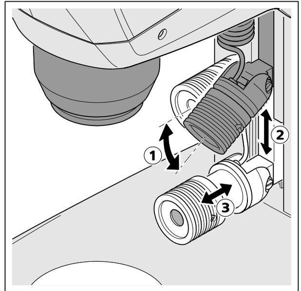
Fig. 15 Réglage du dispositif d'éclairage à spot
