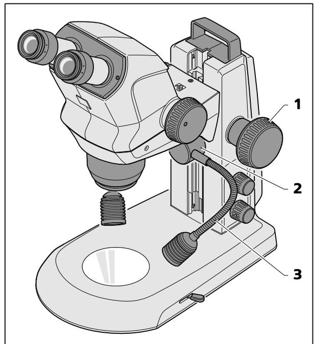
Fig. 16 Dispositif d'éclairage à double spot
