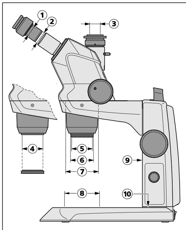
**Fig. 4 Interfaces sur Stemi 508 avec statif K (schéma)**
