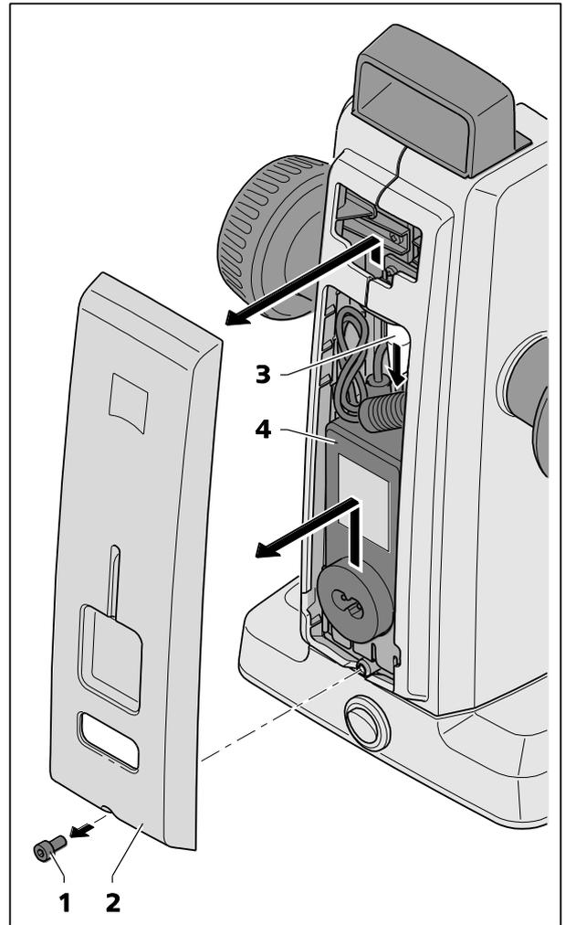
Fig. 21 Remplacement du bloc d'alimentation
