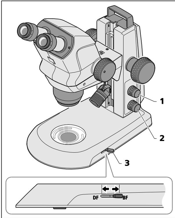
**Fig. 19** Module de lumière transmise dans le statif K EDU
