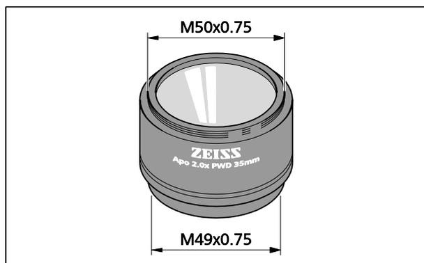
**Fig. 5 Optiques avant, Stemi 508 (exemple)**
