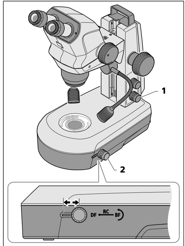
Fig. 20 Unité de lumière transmise dans le statif K LAB
