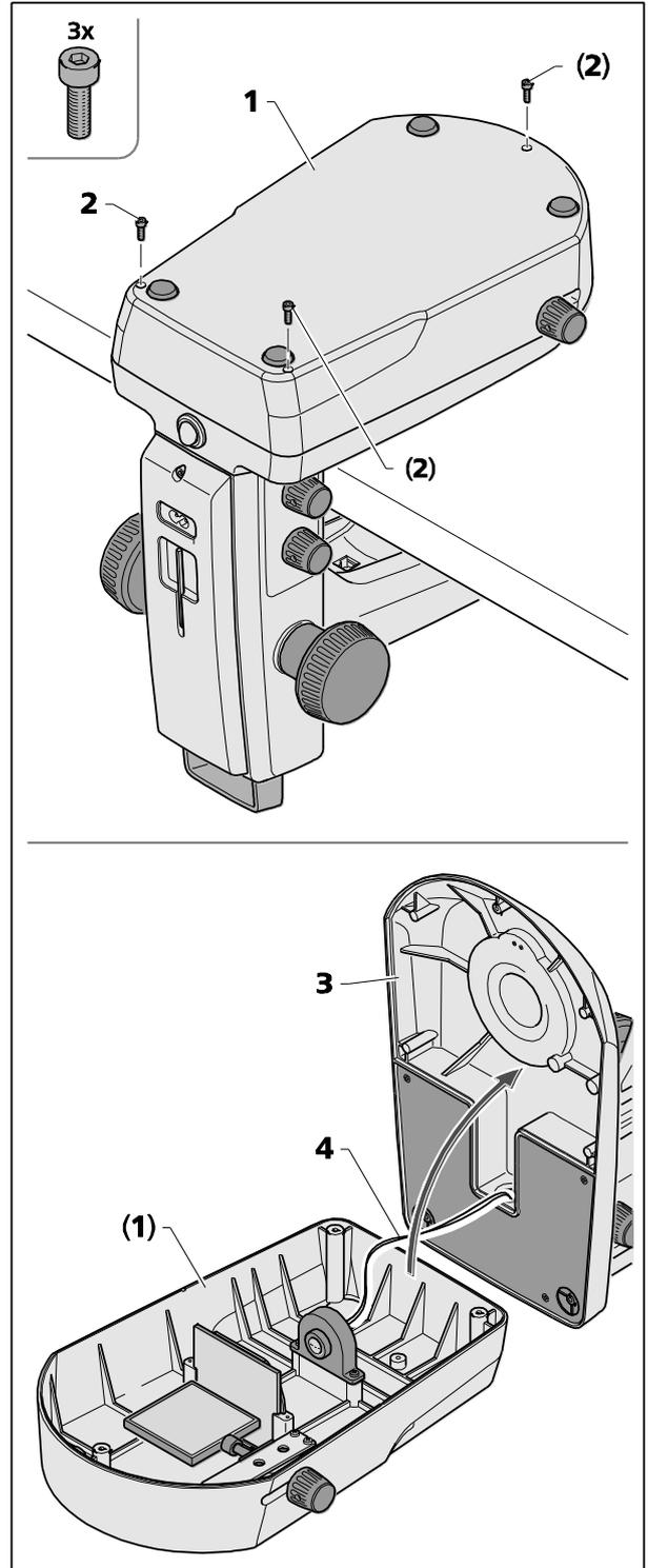
Fig. 23 Ouverture du capot du boîtier du statif, statif K LAB
