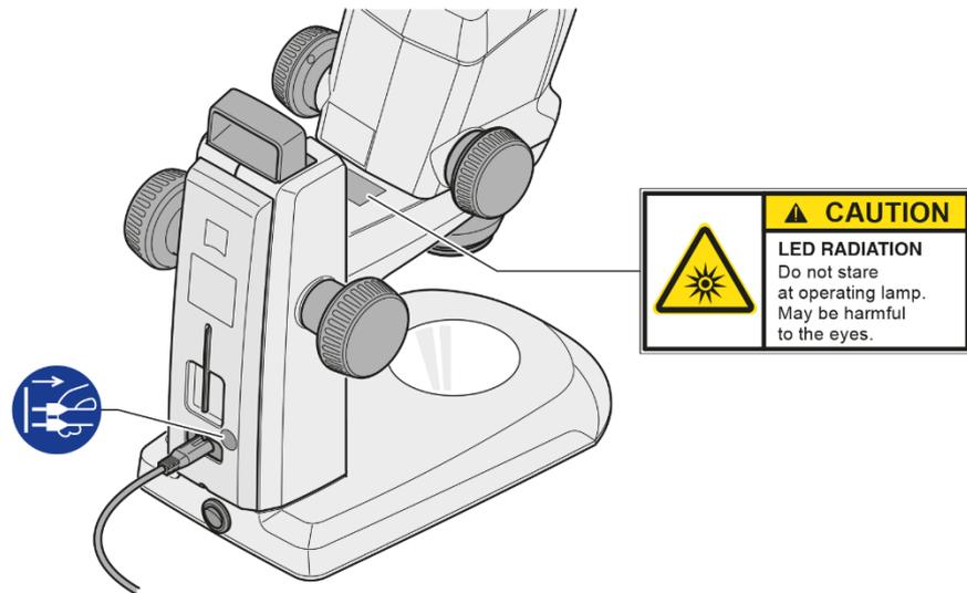
Fig. 1 Étiquettes d'avertissement et d'information sur l'appareil
