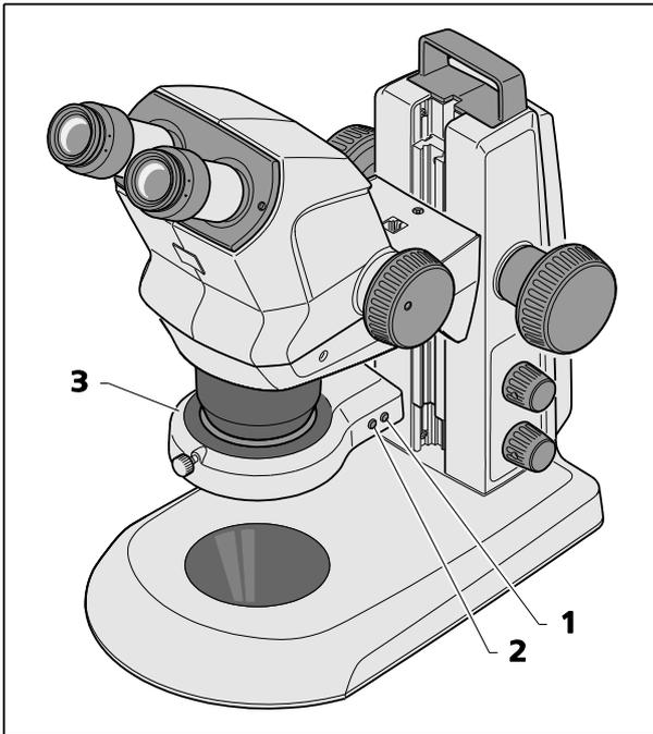
**Fig. 17 Dispositif d'éclairage annulaire**
