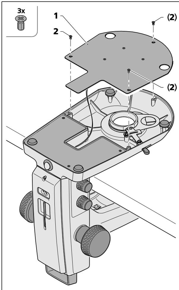
Fig. 22 Ouverture du capot du boîtier du statif, statif K EDU
