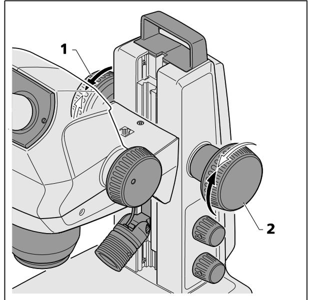
**Fig. 7 Réglage de la fluidité de mouvement de la commande de mise au point**
