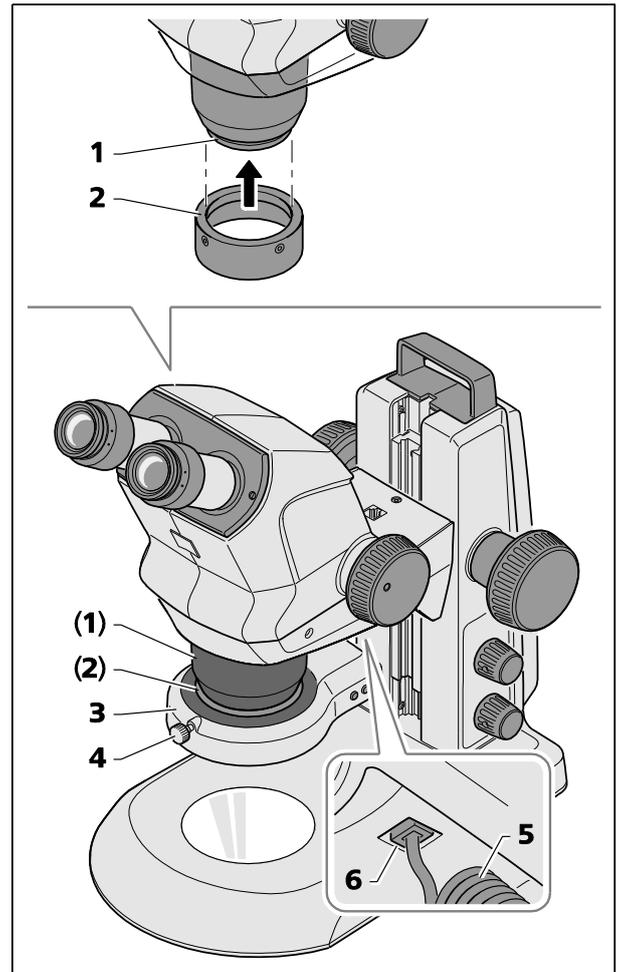
Fig. 9 Montage du dispositif d'éclairage annulaire
