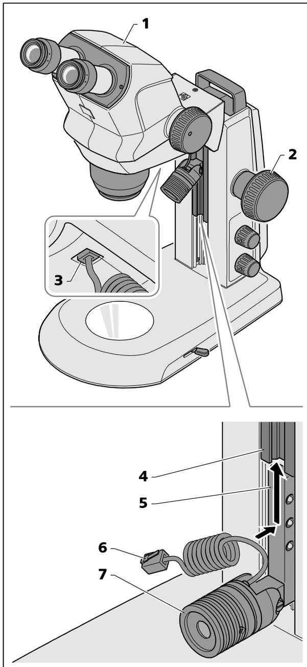
**Fig. 8 Montage du dispositif d'éclairage à spot**
