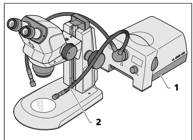
Fig. 10 Montage de l'éclairage externe à fibre optique
