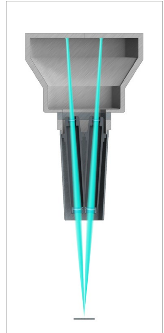
Trajet schématisé des faisceaux d'un microscope stéréo de type Greenough.
