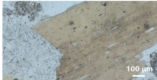
Biotite dans du granite, lumière transmise, champ clair, EC Plan-NEOFLUAR 10x/0,3 Pol
