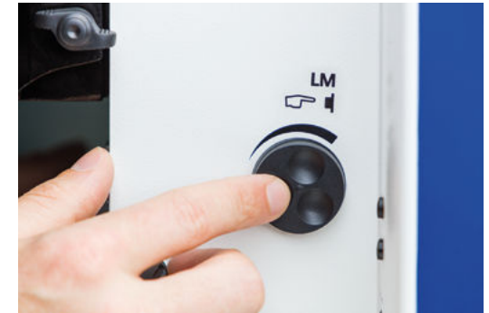
Commande de la gestion d'éclairage
