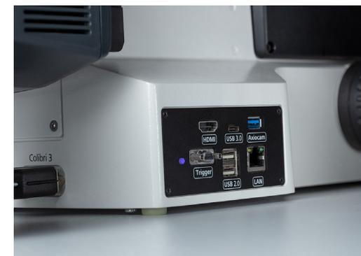
ZEISS Axiocam 5 est livré avec un boîtier de commande intelligent incluant toutes les interfaces directement sur le support afin de pouvoir l'utiliser sans PC.
